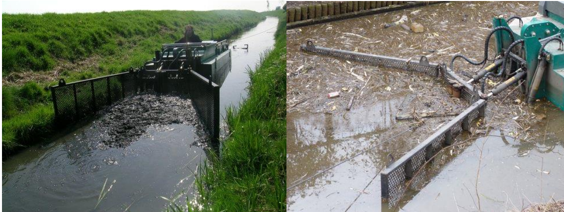
Figuur 17 Op de foto zijn de messen van de veegboot goed te zien in actie (Post & Klein).
