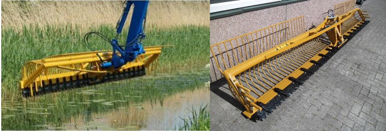
Figuur 15 Bovenstaand een maaikorf bevestigd aan een grijparm en een maaikorf onbevestigd. Op de foto zijn goed de korf (vangt de plantenresten op) en de messen (snijden de planten af) te zien (Hobelman-Halle B.V.).
