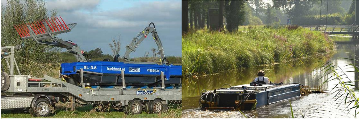
Figuur 18 Op de bovenstaande foto's is links een harkboot boven water te zien. Hierop is goed de hark zichtbaar. Op de rechter foto is de harkboot in actie te zien (Harkboot, sd).
