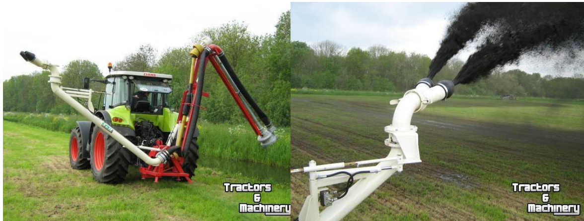
Figuur 23 Links een baggerpomp op een trekker gemonteerd en rechts zie je dat de bagger op de oever wordt gespoten (Tractors en Machinery).
